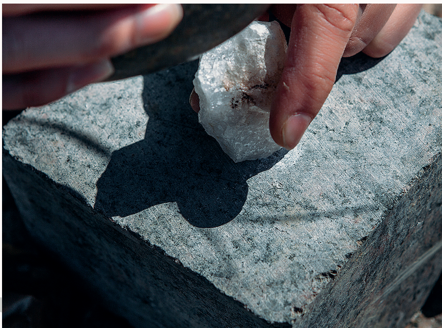
Рис. 3. Следы от работы экспериментальным эталоном, «кремь по граниту»
