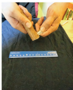
1. Прием членения пластины в щепилке
