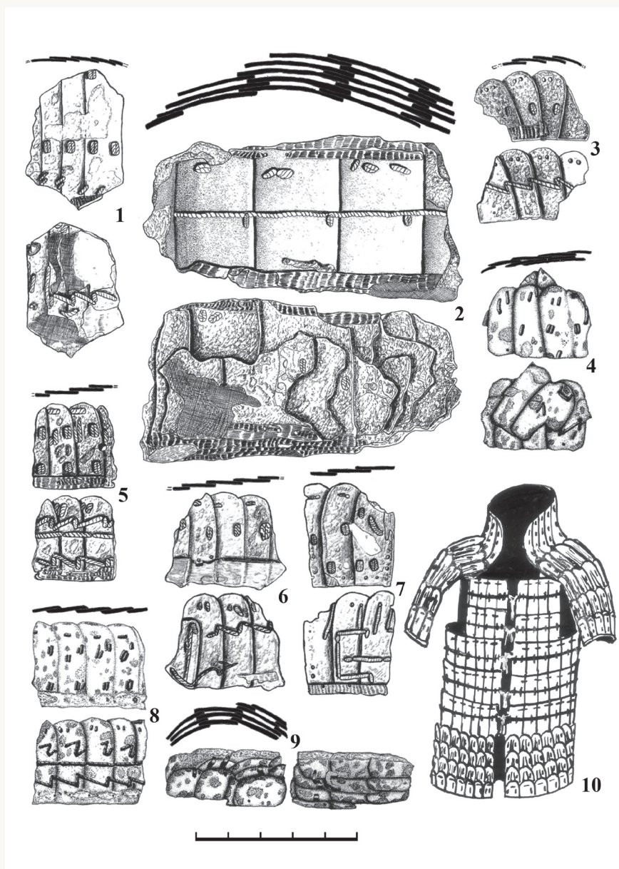
Рис. 3. Железный панцирь из могильника Гол-Мод-2: 1-9 – пластины [по: Эрдэнэбаатар и др., 2015]; 10 – ламеллярный халат (реконструкция В.В. Горбунова, рисунок О.С. Лихачевой)
